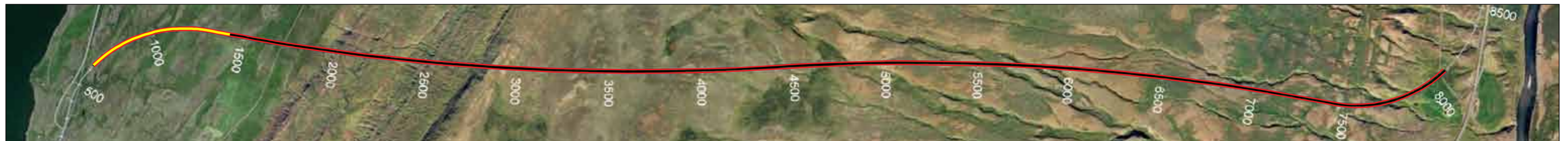
Vaðlaheiðargöng, staða framkvæmda 7. október 2013. Búið er að sprengja 792 m frá Eyjafirði sem er 11,0% af heildarlengd.
