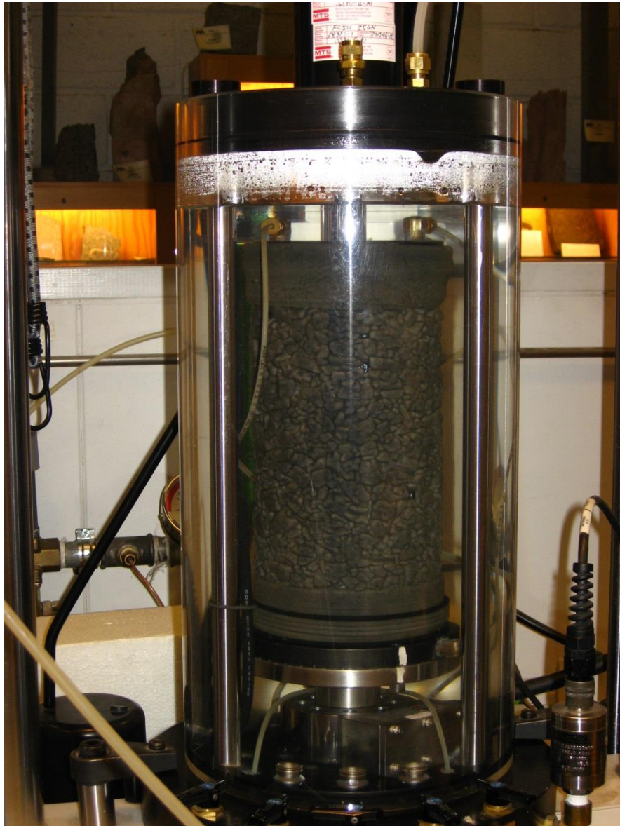
Mynd 3.1. Burðarlagsýni í þrías, tilbúið til prófunar.
